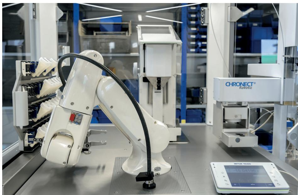
*Der Industrieroboter fürs Labor ist das Ergebnis einer Zusammenarbeit von Mettler-Toledo und Axel Semrau. Links im Bild: Rack mit Dosierköpfen für pulverförmige Substanzen.*
