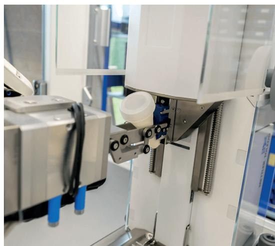
*Der Roboter Chronect platziert einen Dosierkopf im Dosierautomaten, der anhand einer Waage eine definierte Menge einer pulverförmigen Substanz freigibt.*
