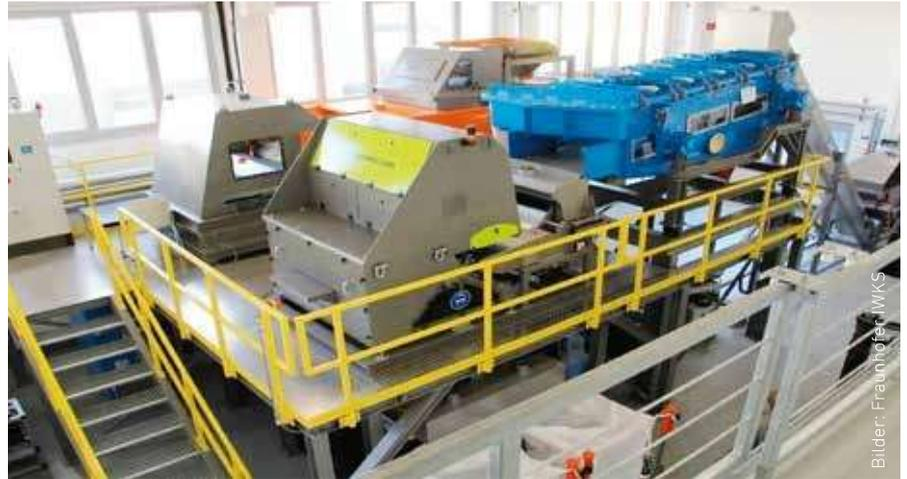
Smarte, modular aufgebaute Multisensor-Sortieranlage, mit der KI-gestützte Trenn- und Sortierkonzepte entwickelt, erprobt und validiert werden.
